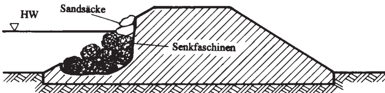
Abb. 25: Abdeckung einer Unterspülung mit Senkfaschinen
