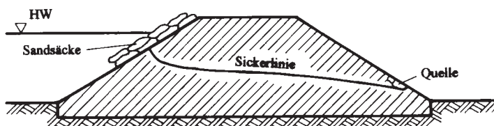
Abb. 28: Abdeckung einer Quelleneintrittsstelle
