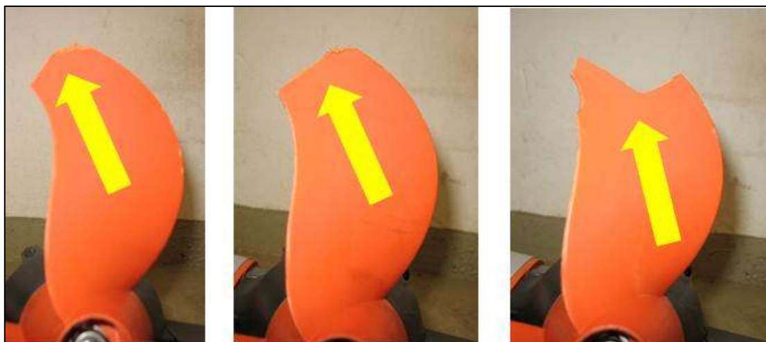
Abbildung 10: Schadbild Motor 2, Schraube
