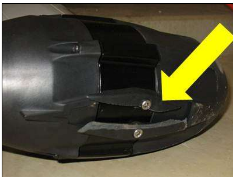
Abbildung 11: Schadbild Motor 2, Finne
