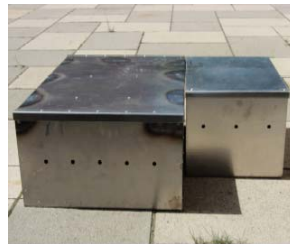
Abb. 4.3: Sedimentationskästen (Beispiele) in den Bundesländern Schleswig-Holstein, Bayern, Umweltprobenbank (UBA), Sachsen (von links nach rechts:)
