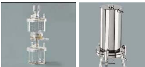
Abb. 4.5: Druckfiltration (z.B. Celluloseacetatfilter, < 0,45 \mu\text{m} )
